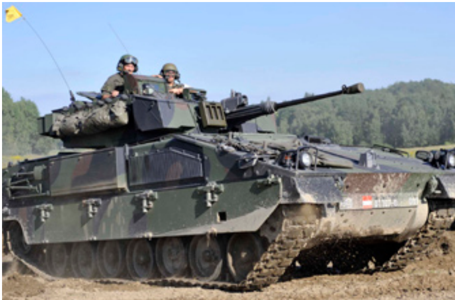
Très similaires, l'Ulan (Autriche) et le Pizarro (Espagne) sont les déclinaisons d'un ASCOD initialement fruit d'une coopération bilatérale entre les deux pays. À présent, le système relève du catalogue... de l'américain General Dynamics. (© Bundesheer)
