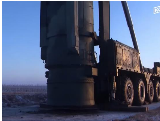
SYSTEME DE CHASSE A POUVRE, PERMETTANT LE LANCEMENT A FROID DU MISSILE
