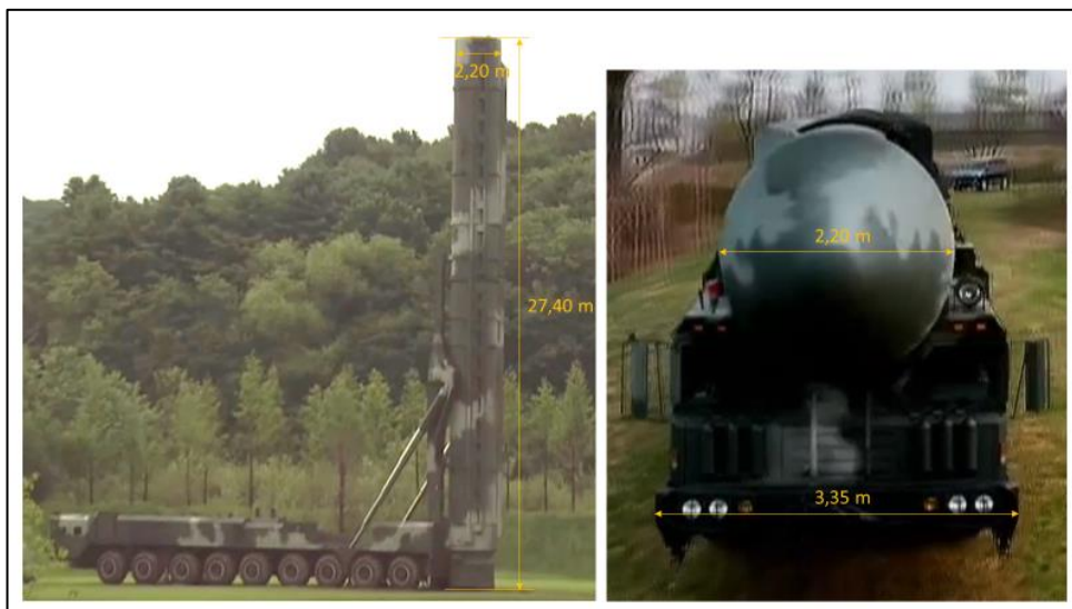
DIMENSIONS ET PROPORTIONS DU TUBE DE LANCEMENT (CREDITS EXTRAITS VIDEOS : KCNA)
