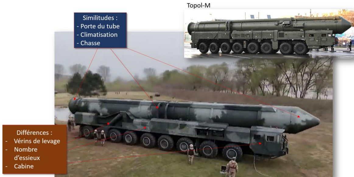
SIMILITUDES /DIFFERENCES ENTRE LES TEL DU HS-18 ET DU TOPOL-M
