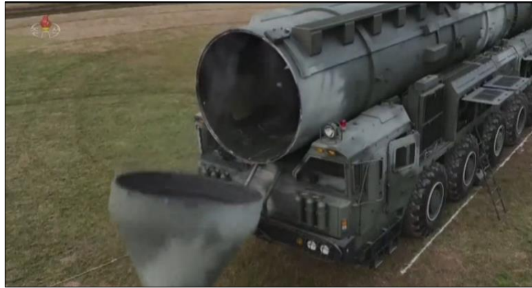
EJECTION PYROTECHNIQUE DE LA PORTE DU TUBE AVANT LANCEMENT (CREDITS : KCNA)
